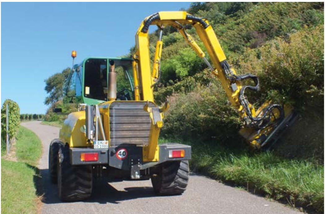
Abbildung 1: Ausleger-Mulcher im Einsatz
